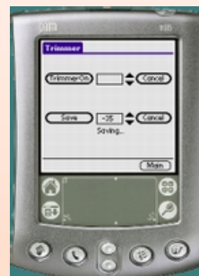
Test Attivo/Settaggio Attivo: usa la modalità Test Attivo per controllare serpentine, iniettori, contagiri, pompa del carburante, contachilometri, cancellare la cronologia degli errori e modificare il consumo del carburante.
